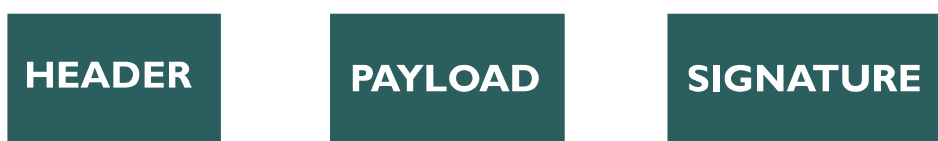
Figure 9 : La structure d'une JWT
